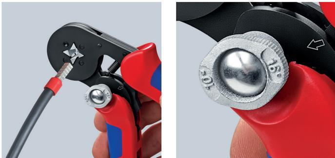
切换档位，可以切换压接能力：10mm<sup>2</sup>与16mm<sup>2</sup>
